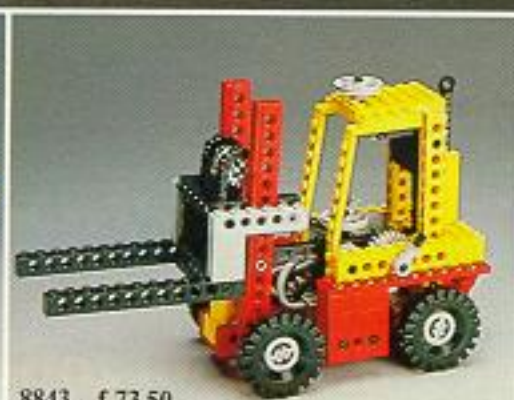
8843 f 73,50 Perslucht Heftruck met pneumatisch hefmechanisme.
